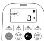
スタートを押すとゼロ点補正を行ない、計測を再開します。
