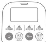
計量モード、記録モードおよび機器設定モードで **電源** を 1 秒以上長押しすると待機モードに戻ります。
