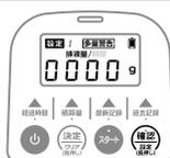
計測中または確認画面で $\text{確認}$ を1秒以上長押しすると多量警告の排液量設定画面に移行します。(P.24 で計測スタート前に設定した数値が表示されます)
