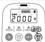
警告が発生した場合は、警告ランプが点滅し、警告音になります。また、**(確認ランプ)**の橙色ランプが点灯し、表示部に警告の内容が点滅表示されます。
