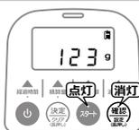
(確認)を押すと、確認画面に移行した直後の計測値の表示に戻ります(ボタンを押した時点の値を表示していますが、計測は継続しています)。
