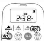
▲を押すと、計測開始からの経過時間が表示されます。また、(確認) (橙色) と ▲経過時間 (青色) のランプが点灯します。
