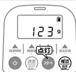
計測中に(記録確認)を押すと「計測中」表示が消え、スタートのランプが点灯し、記録確認画面に移行します(ボタンを押した時点の値を表示しています)。
