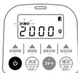
計測を停止・中止する場合は、**電源** を 1 秒以上長押しすると、待機モードに戻ります。
