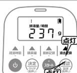
▲を押すと、最新記録の一つ前の記録間隔に計測した排泄量が表示されます。また、(確認) (橙色) と ▲過去記録 (青色) のランプが点灯します。
