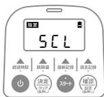
待機モードで **⏻** を 2 秒以上長押しすると機器設定モードに移行します。
