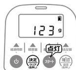
$\text{確認}$ を押すたびに、各設定内容が表示されます。容量警告で $\text{確認}$ を押すと、 $\text{スタート}$ のランプが点灯します。
