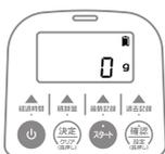
待機モードで **⏻** を押しすると計量モードまたは記録モードに移行します。ご使用になるモードは、あらかじめ機器設定モードで設定しています。計量モードの場合は「SCL」、記録モードの場合は「rEC」が約 1 秒間表示されます。
