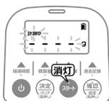
ゼロ点補正中は約 5 秒間、「計測中」が点滅し、数値は「----」で点滅します。
