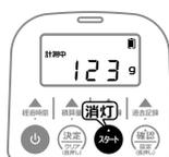
$\text{スタート}$ を押すと、「計測中」が点滅表示され、計測を再開します。
