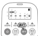
ゼロ点補正中は約 4 秒間、「計測中」が点滅し、数値は「----」で点滅します。
