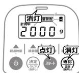
**(確認ランプ)**を押すと、警告ランプが消灯し、警告音は停止します。また、**(確認ランプ)**のランプは消灯し、**(スタート)**のランプが点灯します。
