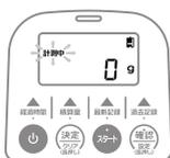
計測中に **準備** を押し「容器」の表示が消え、容器重量を差し引かない排液量表示に切り替わります。
