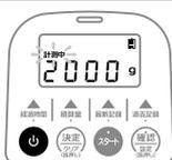
計測を停止・中止する場合は、**電源** を 1 秒以上長押しすると、待機モードに戻ります。なお、記録データは消去されます。
