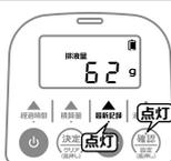
▲を押すと、ボタンを押した時点を含む、最新の記録間隔に計測した排泄量が表示されます。また、(確認) (橙色) と ▲最新記録 (青色) のランプが点灯します(記録間隔は、機器設定で行います。P.5)。
