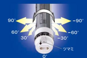
ソケット部のツマミを開放することで照射角度を30°刻みで7段階（-90°～+90°）変更できます。
